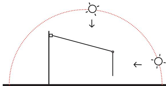
Le système MODULBOX-400 permet l'incorporation de SOMBREX dans toutes les options de configuration. Ce lambrequin optimise les performances du produit en offrant une meilleure protection solaire, même lorsque la position du soleil est basse sur l'horizon.
